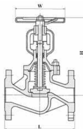
**Примечания:** KV45 обладает улучшенной конструкцией уплотнения — сиффоном из нержавеющей стали, благодаря чему исключаются утечки по штоку. Данный тип клапана не требует сервисного обслуживания, т. к. в конструкцию кроме сальникового уплотнения включен сиффон.
